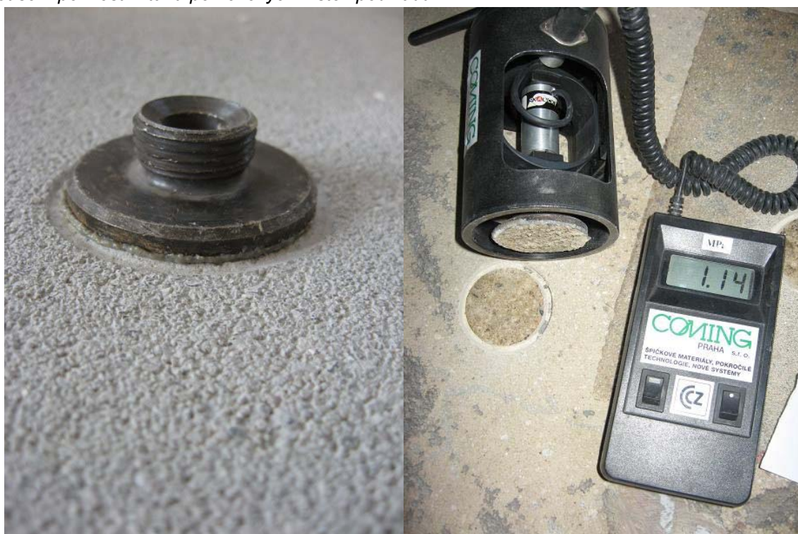
Zkoušení pevnosti v tahu povrchových vrstev podkladu:
